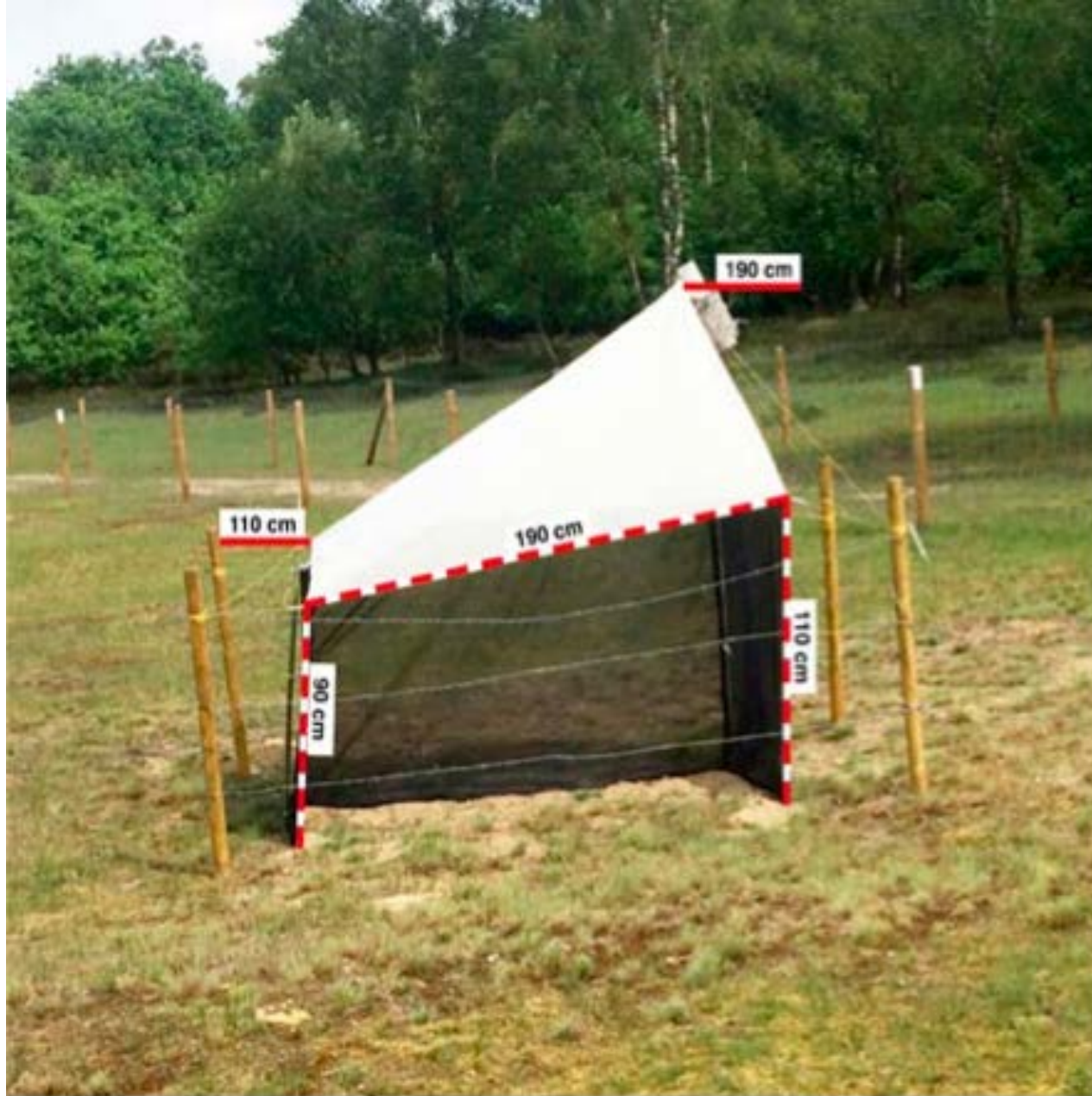
Abbildung 5. Malaisefalle (Townes-Modell) im Bautyp des Entomologischen Vereins Krefeld mit Bemaßung (© M. Sorg/EVK)
